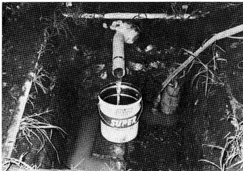
写真4 流量観測点 Photo 4 Runoff measurement.
