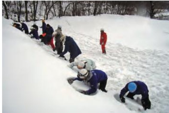
写真2 雪を切り出し雪崩の起きやすい層を調べる講習
