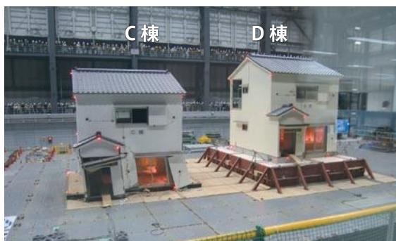
写真2 JR鷹取波100%1回目加振後のC棟、D棟
