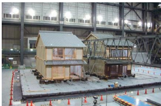
写真3 平成17年度の伝統構法木造建物試験体
