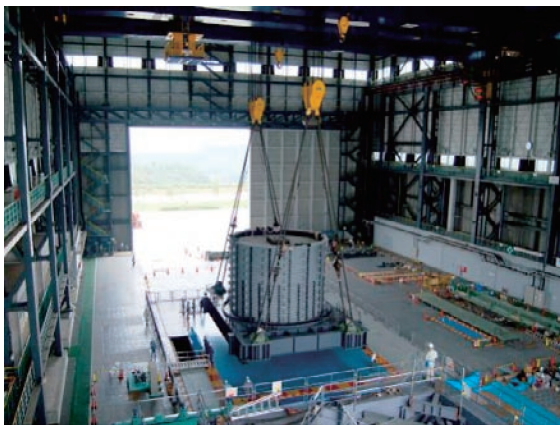
写真1 水平地盤実験の地盤モデルの震動台上への設置 (吊上げ時質量約750t)
