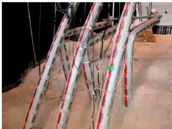
写真6 折れ曲がった杭
