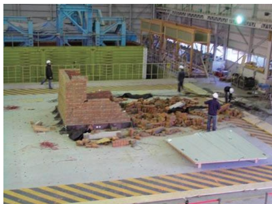
写真2 崩壊したモデルレンガ試験体
