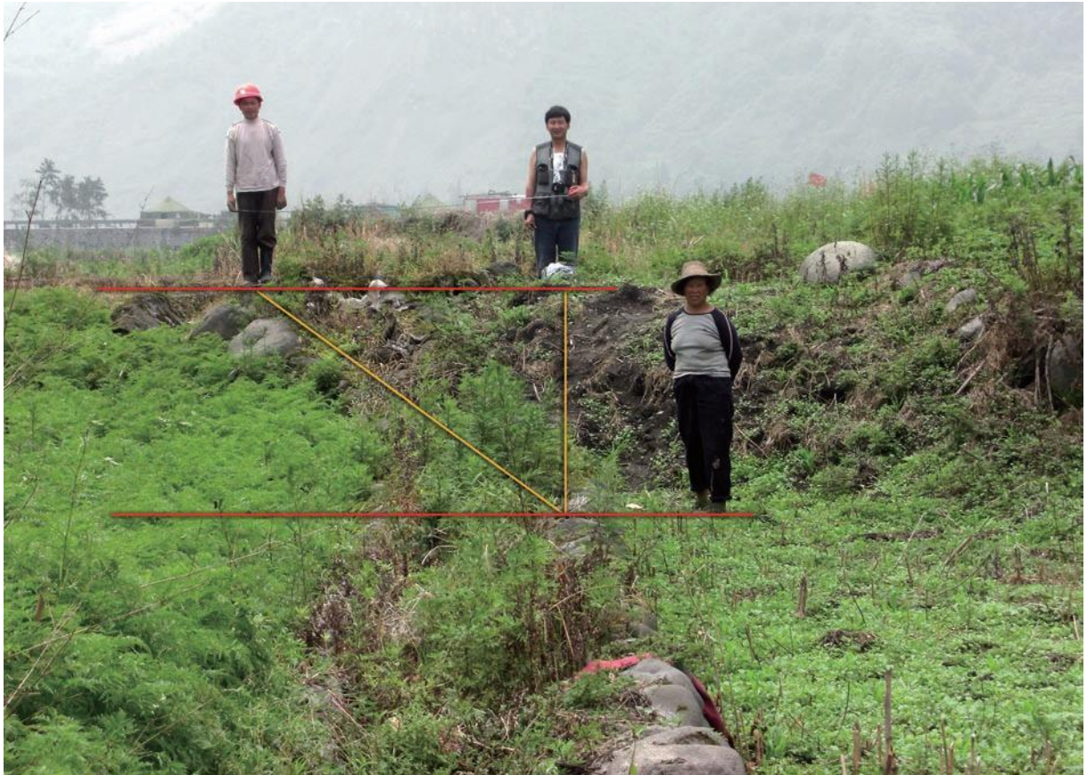
写真2 龍門山主断層帯と走行が違う北西方向の断層が小魚洞鎮付近に現れ、縦ずれ1.5m、横ずれ2.8mが確認されました。
