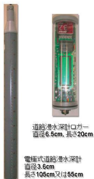
図3 道路浸水深計の外観
