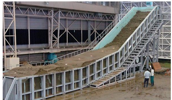
写真2 崩壊実験例（崩壊後）
