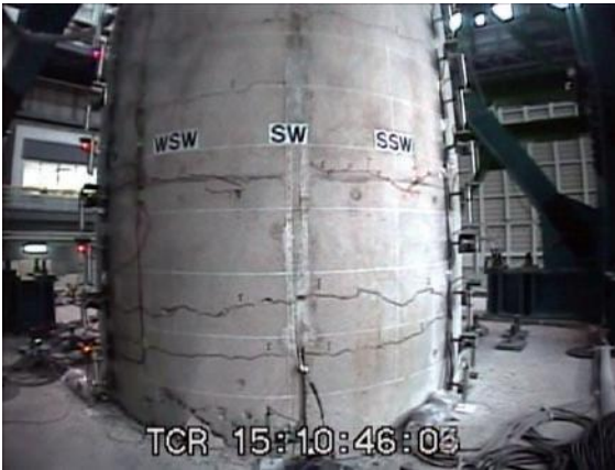
写真3 現行基準の橋脚（兵庫県南部地震程度の揺れの後）。大きな被害は見られず、軽微な補修をすれば使用可能。
