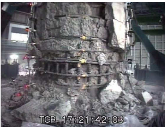
写真4 現行基準の橋脚（余裕検証後）。現行基準では、以前の基準よりも多くの鉄筋が使用されているので耐力の向上がみられる。錘を1.2倍とし震動台の揺れを1.25倍として2回揺らせた結果、内側のコンクリートが鉄筋より外へ割れ出た。
