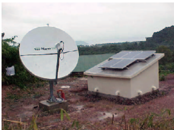
写真4 衛星テレメタ地震観測点
