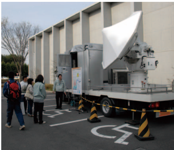
研究交流棟前の車載型気象レーダ
