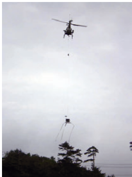
写真2 無人ヘリによる地震計の設置風景
