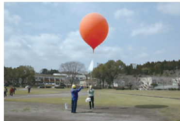
写真3 火山灰を観測するためのラジオゾンデの放球
