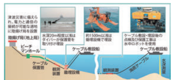
図2 海洋部の建設工事概要
