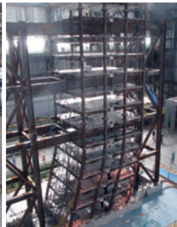
写真2 実験後の超高層骨組
