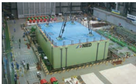
写真2 三次元継手など部品交換のため震動台を外す
