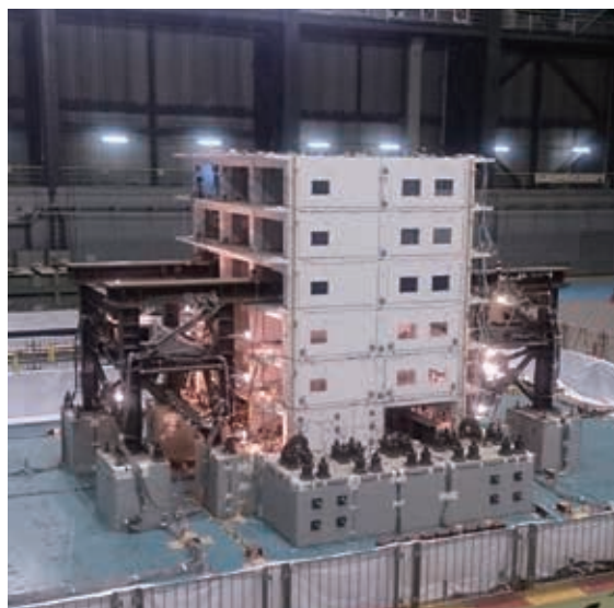
写真1 RC造6層建物の30%縮小試験体
