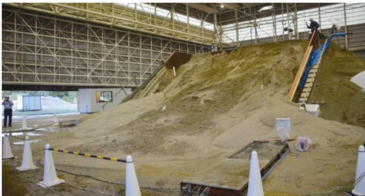
降雨による斜面崩壊後の様子
