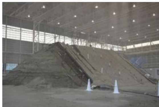
降雨実験中の斜面の様子
