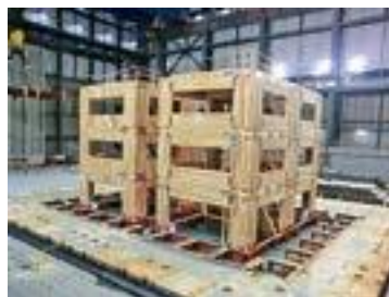
写真1 震動台搭載状況（D棟・E棟）
