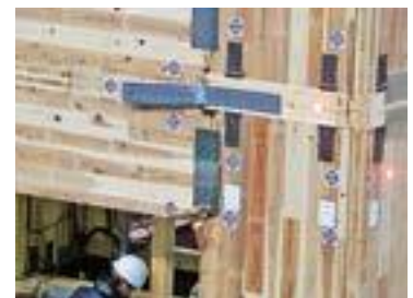
写真2 E棟小型パネル接合部の損傷状況（JMA神戸波加振後）
