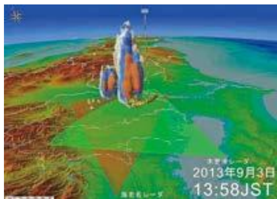
図1 防災科研の2台のXバンドMPレーダで観測したレーダ反射因子の3次元分布。白・青・橙色の等値線は、それぞれ30 dBZ、40 dBZ、50 dBZのレーダ反射因子（降雨強度換算でそれぞれ3 mm/時、12 mm/時、49 mm/時）を示します。図中の赤球は防災科研が調査した竜巻による被害地域を示し、黄色の印は落雷位置を示します。図中の矢印は高度18 kmの高さを示すスケールです。図中の赤色と緑色の扇形は、MPレーダそれぞれの観測範囲を示します。地図情報は国土地理院地図（色別標高図）を利用。
