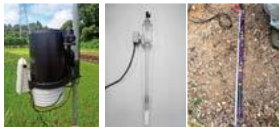
図4 設置センサ 雨を測るセンサ（転倒ます式雨量計） 水圧を測るセンサ（テンシオメータ） 水分量や斜面傾斜を測るセンサ（マルチセンサ）
