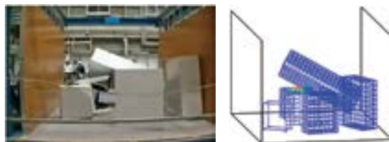
図3 家具の転倒挙動解析
