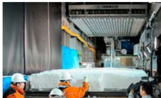
写真1 雪の積もった屋根に雨が降った場合の荷重増加に関する実験
