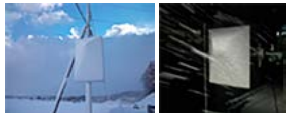
図2 道路標識着雪(左)と風洞再現試験(右)
