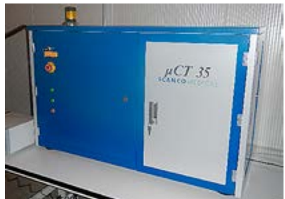
写真1 X線CT装置（雪氷試料用）
