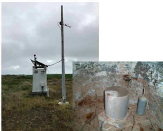
写真1 眼鏡岩観測点 (右下：地下壕内の地震計)
