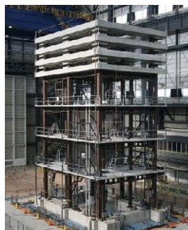
写真2 骨組の耐震性に関する実験用試験体
