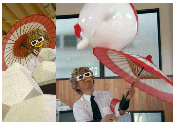
写真5 傘回し型定常落石シミュレータ
