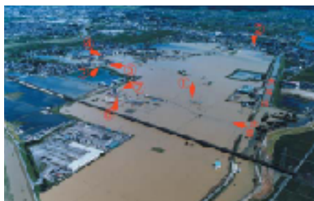
写真1 大垣市荒崎地区浸水状況、①は写真2、②は写真3、③は写真4の撮影位置。洪水痕跡調査地点の④は175cm(盛土高90cm)、⑤は175cm(盛土高75cm)、⑥は176cm、⑦は231cm(アジア航測株式会社提供、11日9時頃撮影)
