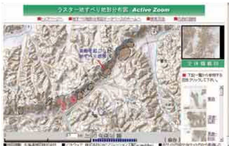
図1 地すべり地形分布図と村田町地すべりの発生位置（矢印の先） インターネットの公開画面に加筆
