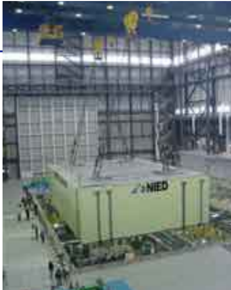
震動台据付状況
