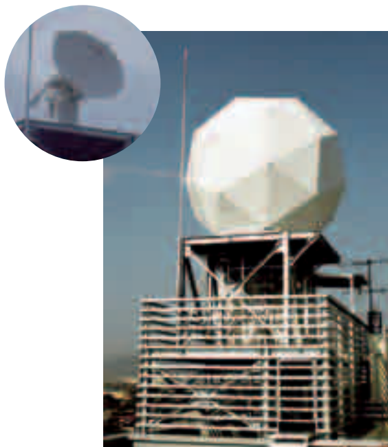
図1 海老名市に設置されたMP-Xレーダ。丸内は、レドーム（ドーム状の保護覆い）を被せる前の写真。
