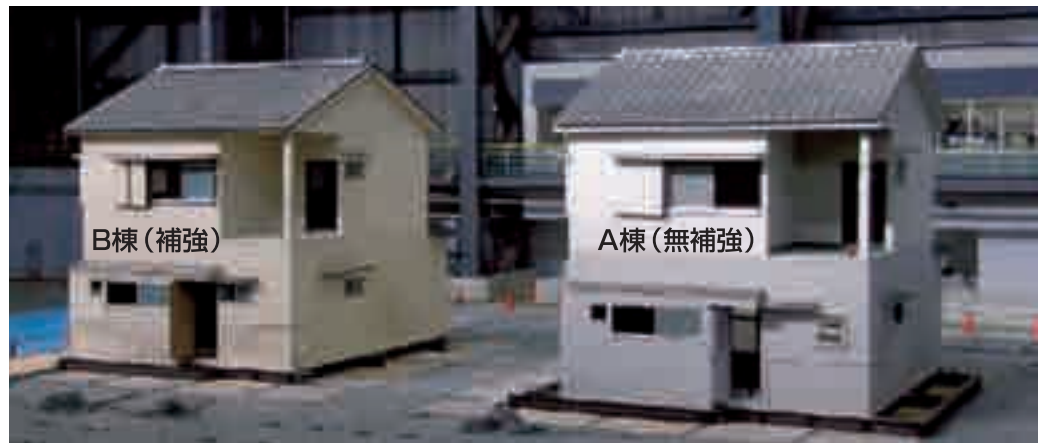
図9 震動台上の移築住宅補強住宅と無補強住宅
