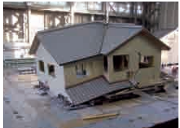
図4 J R 鷹取 3 回目の加振で倒壊
