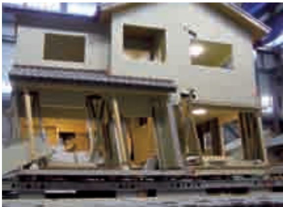
図3 J R 鷹取 2 回目の破損
