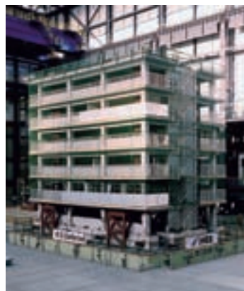
兵庫耐震工学研究センター・E-ディフェンスと、鉄筋コンクリート建物破壊実験
