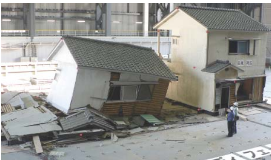
写真1 木造建物無補強・補強の比較実験
