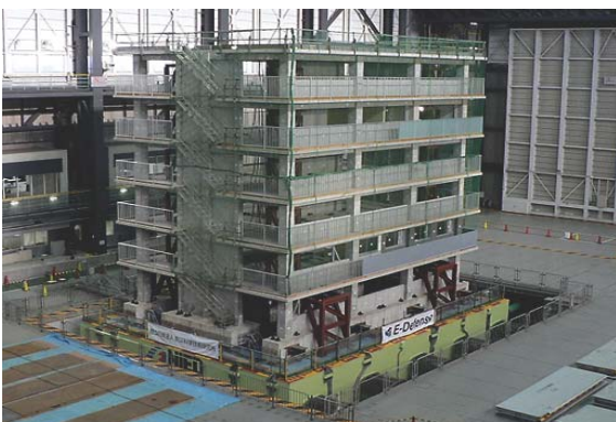
写真2 6階建て鉄筋コンクリート建物実験
