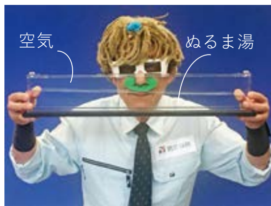
図1 なだれシミュレータ「ナダレンジャー 2号」改め、「ベナール戦隊タイリュウジャー」を抱えるDr.ナダレンジャー。中に入っているのはぬるま湯と空気のみ。
