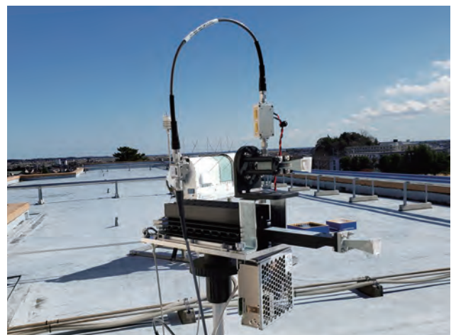
写真2 電波状況調査用の受信機
