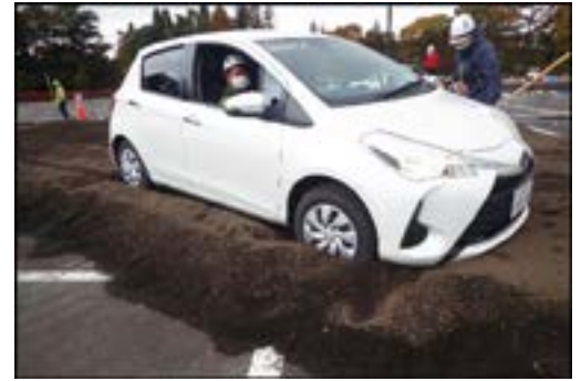
写真1 富士山北麓で実施した火山灰上車両走行実験
