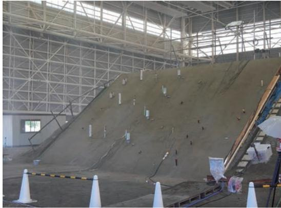
図1 IoT崩壊予測センサーの検証実験
