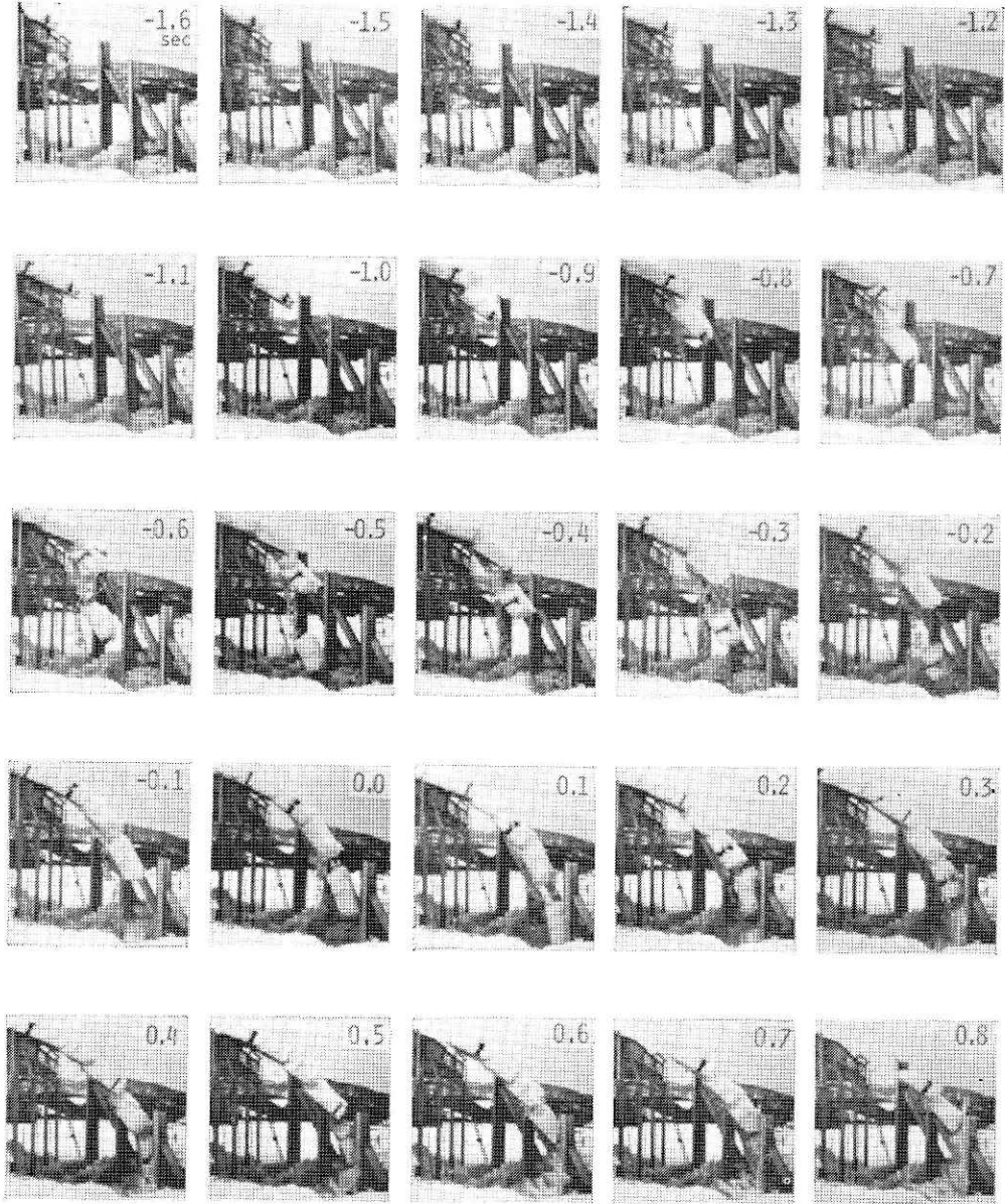
写真 9 屋根 R_c から滑落する雪塊が測定壁 W_c に衝突する状況。右肩の数字は写真番号を示すと同時に経過時間（単位：秒）を表わし、図12の時間軸に合致させてある。
