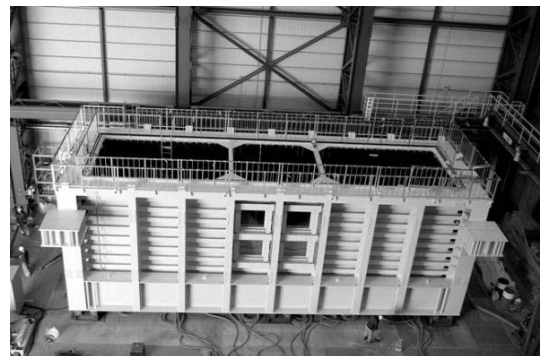
写真3.2 直方体剛体土槽 Photo 3.2 Rectangular rigid container.
