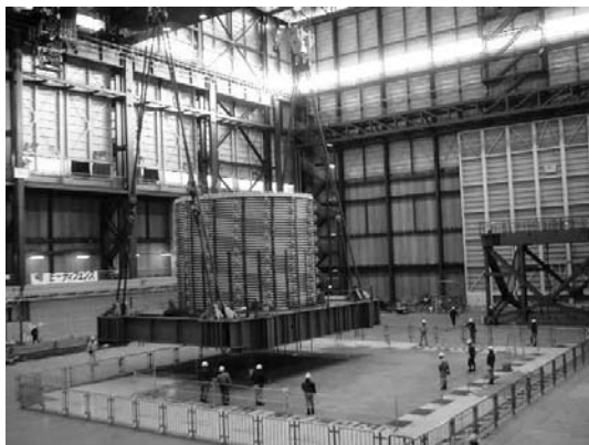
写真2.11 試験体の震動台上への設置 Photo 2.11 Specimen set on the shaking table.
