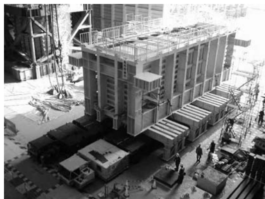
写真3.7 試験体の震動台への運搬
