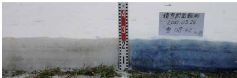
付図 1.9 積雪断面観測図(上)と写真(下)
