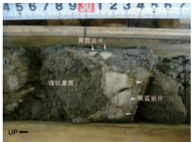
写真6 深度 34.3 m, 安山岩質凝灰角礫岩(火砕流堆積物) Photo 6 Andesitic tuff breccia (pyroclastic flow deposit): 34.3 m deep.
