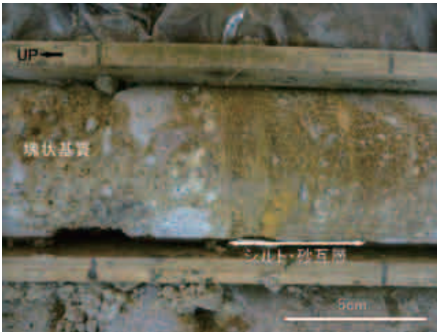
写真 13 深度 73.5 m, 部分的に成層構造が存在する凝灰角礫岩(土石流堆積物)
