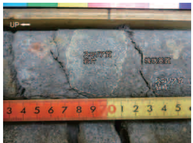
写真 24 深度 199.7 m, スコリア質凝灰角礫岩 (土石流堆積物) Photo 24 Scoriaceous tuff breccia (debris flow deposit): 199.7 m deep.
