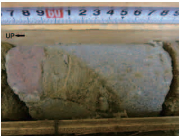
写真 15 深度 105.6 m, 安山岩塊の間に存在する砂・シルト互層
