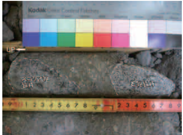
写真 22 深度 176.2 m, スコリア質凝灰角礫岩 (土石流堆積物) Photo 22 Scoriaceous tuff breccia (debris flow deposit): 176.2 m deep.
