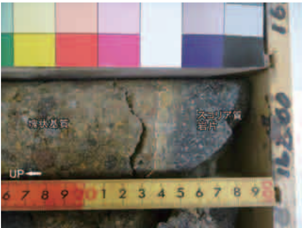
写真 21 深度 161.9 m, スコリア質凝灰角礫岩 (土石流堆積物) Photo 21 Scoriaceous tuff breccia (debris flow deposit): 161.9 m deep.
