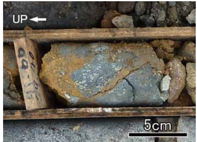
写真13 深度91.7 m, ジグソー状に割れた安山岩岩塊 Photo 13 A jigsaw Cracked andesite block: 91.7 m deep.
