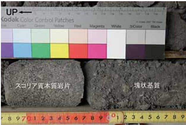
写真 6 深度 59.8 m, 安山岩質凝灰角礫岩(火砕流堆積物) Photo 6 Andesitic tuff breccia (pyroclastic flow deposit): 59.8 m deep.
