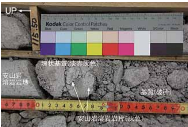
写真16 深度116.6 m, 凝灰角礫岩(安山岩岩塊を本質物質として含む火砕流堆積物) Photo 16 Tuff breccia (andesitic block and ash flow type pyroclastic flow deposit): 116.6 m deep.
