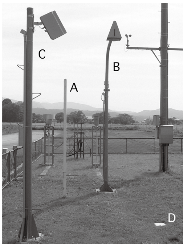
図 5 雪尺 (A), 超音波式積雪深計 (B) およびレーザー光波位相差検出式積雪深計 (C) とその 0 レベル基準面 (D)
