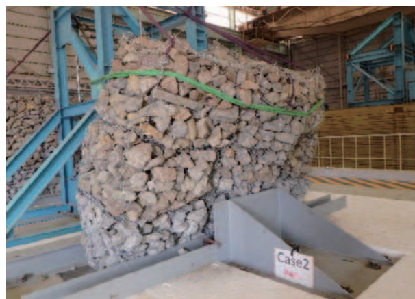
写真 4 蛇籠壁の振動実験による残留変形
