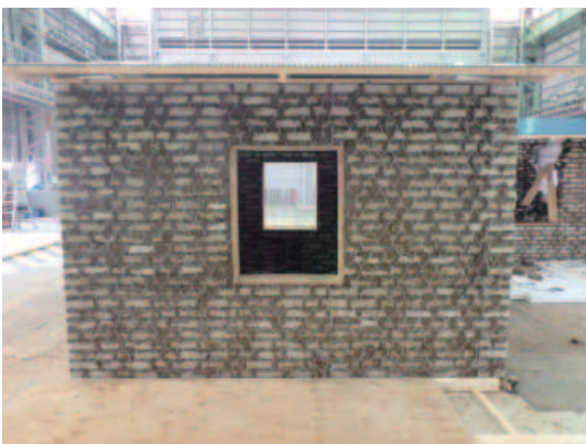
(d) ジャケッティング補強(側面)
