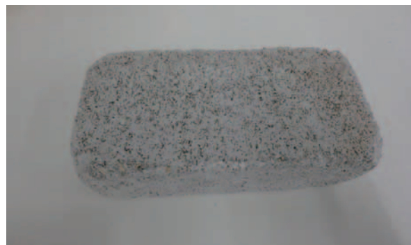
写真7 セメントレンガ Photo 7 Cement brick.
