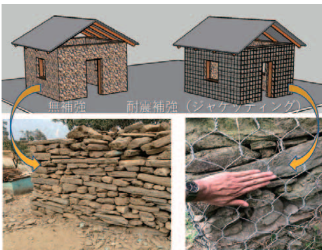
図2 ジャケッティング工法の概念図 Fig. 2 Conceptual diagram of the jacketing method.
