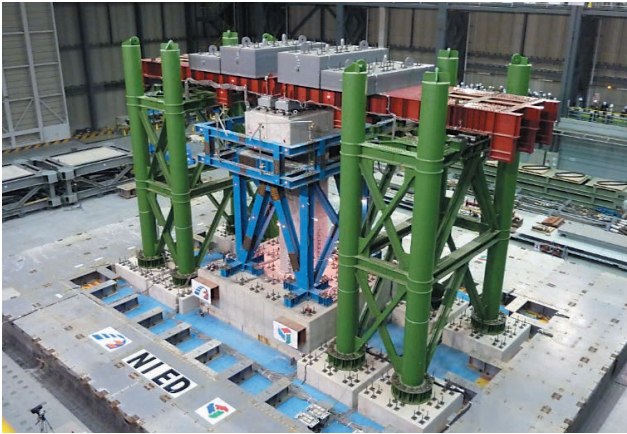
写真 6.1 E-Defense にセットされた C1-6 橋脚 Photo 6.1 Experiment set-up of C1-6 Column on the E-Defense shake table.
