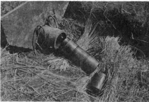
写真-1 薬量25 grでSH波発生装置から飛び出した重錘
