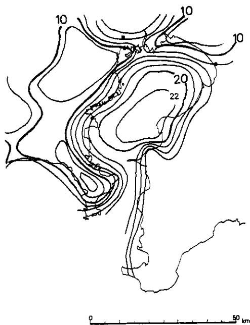
図-4 等風速線図 (昭和41年6月28日20時)
