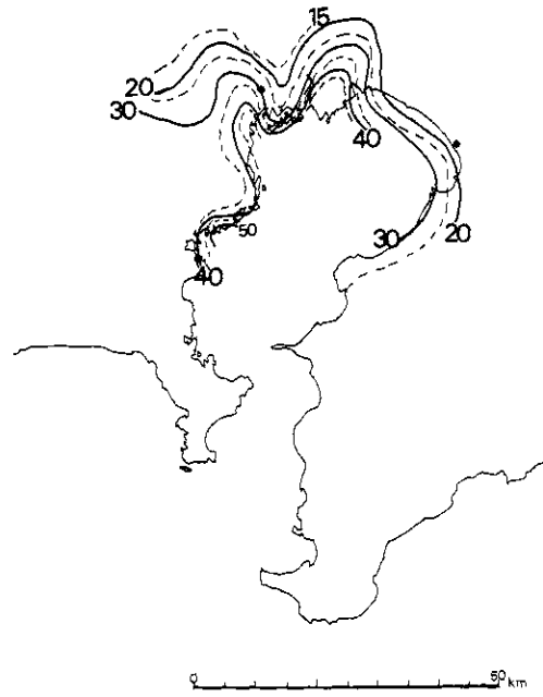
図-29 SSEの風向の場合の推定風速分布図
