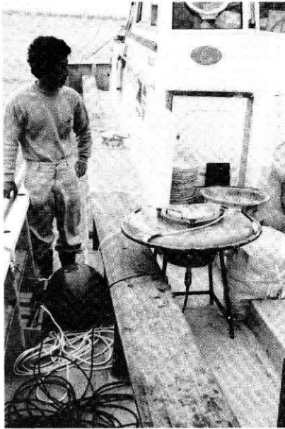
写真1 吊り下げ圧力式波浪計 Photo 1 Pressure type wave meter.
