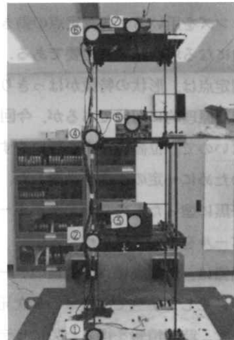
写真1 三層骨組モデルの振動実験
